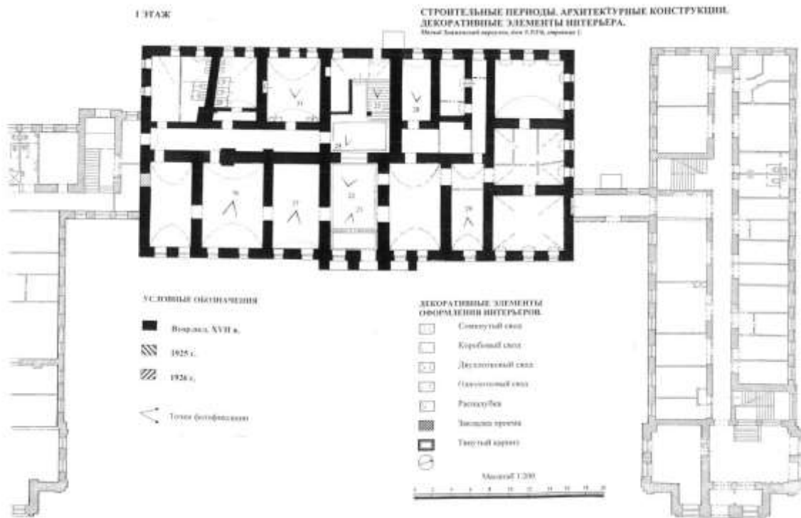
План 1-го этажа строения 1. Из материалов обследования домовладения М. Знаменский пер., 3/5, выполненного Историко-архитектурной мастерской №17 «Моспроект-2» в конце 1990-х гг.
